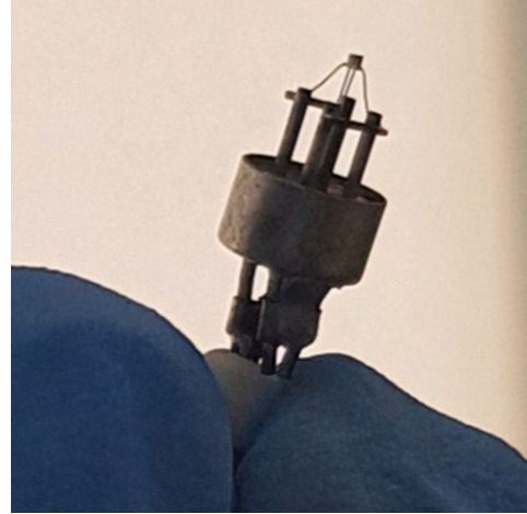
Rysunek 2.9: Zdjęcie katody - metalowym elementem o średnicy 0.5 mm umieszczony na czterech filamentach
