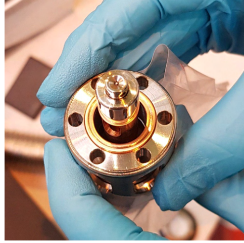
Rysunek 2.11: Zdjęcie katody wraz z otaczającą ją elektrodą
