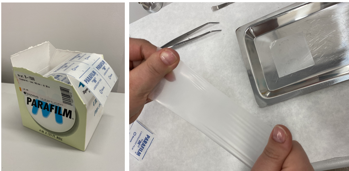
Rysunek 8. Parafilm wykorzystywany do uszczelnienia źródła; folia ta charakteryzuje się dużą plastycznością, dlatego możliwe jest rozciągnięcie jej nawet do bardzo cienkiej warstwy.
