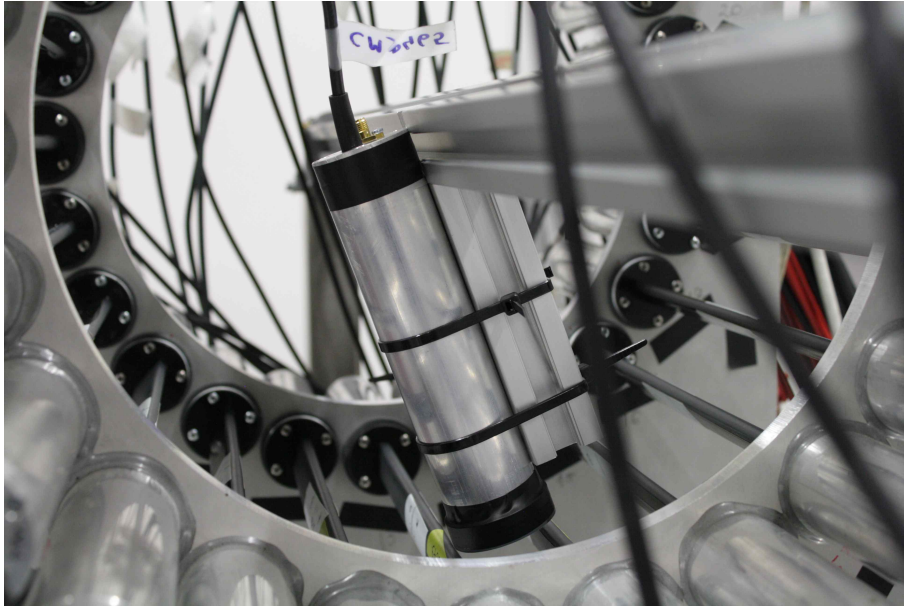
Rysunek 7.8: Zdjęcie detektora referencyjnego do koordynacji czasowej między modułami detekcyjnymi zamontowanego w prototypie tomografu J-PET na ramieniu umożliwiającym obrót detektora.
