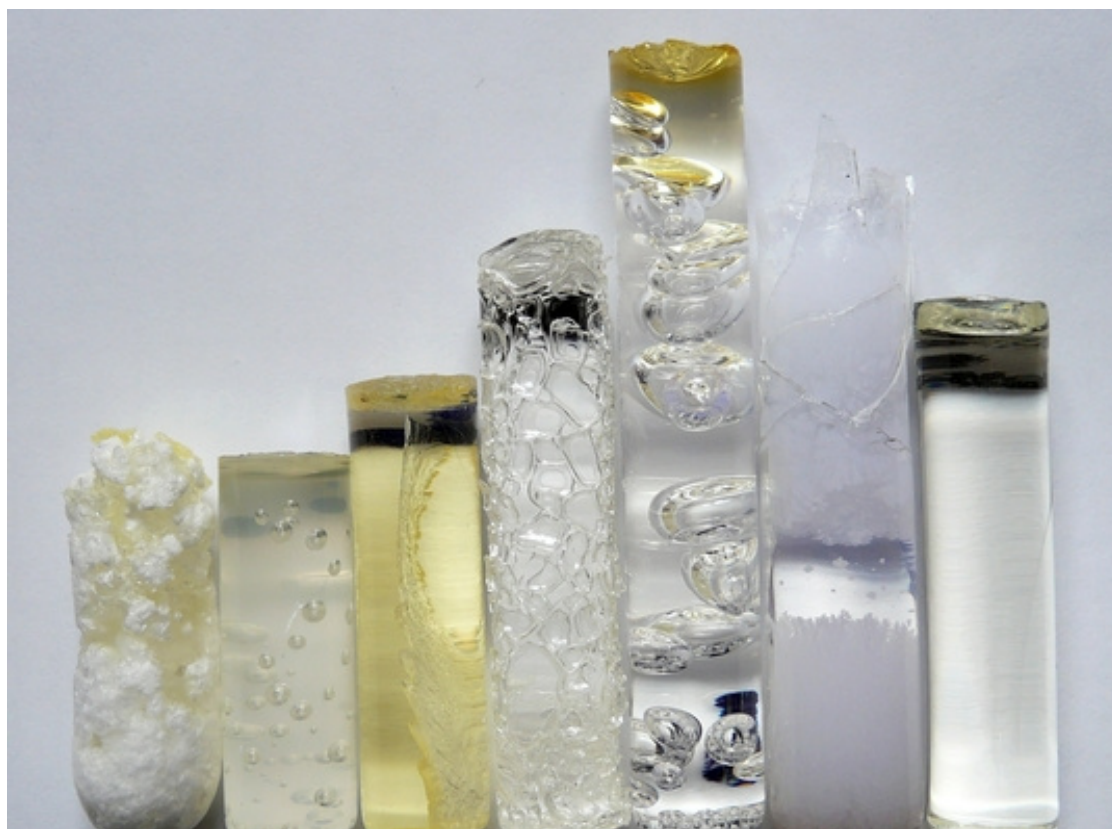
Rysunek 16. Wybrane próbki polimerów z defektami optycznymi; od lewej: krystaliczny polistyren, zmętnienie w całej objętości, pęknięcie (srebrzenie), złuszczenie powierzchni, bąble i żółknięcie, krystalizacja polistyrenu, defekt kształtu.
