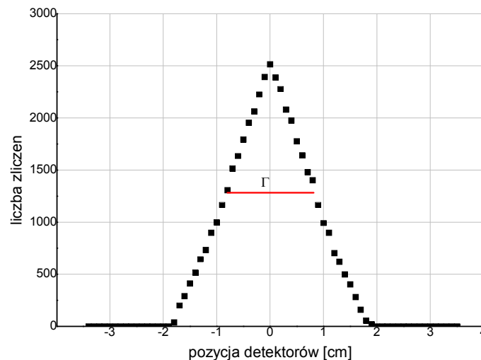
Rys. 32. Zależność liczby zliczeń w funkcji położenia detektorów dla źródła punktowego.
