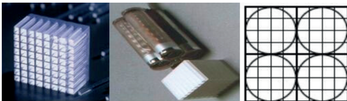
Rys. 2 (lewy) Nacięty blok kryształu używany w obecnych tomografach PET; (środek) Typowa konfiguracja fotopowielaczy konwertujących impulsy świetlne powstające w kryształach na impulsy elektryczne; (prawy) Schemat kryształu i powierzchni czulej fotopowielaczy
