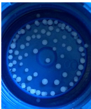
Rys. 20. Zdjęcie polimeru XAD4 wykorzystywane w pomiarach..
